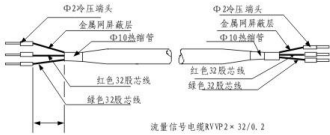
图 3 方表接传感器信号线处理与标示
